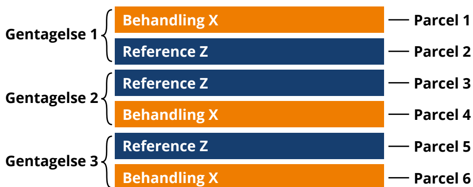
Figur 3: Høst alle parceller med behandling X (de orange). Registrer udbyttet per parcel, og når alle parceller med behandling X er høstet tømmes tanken, og mængden vejes. Derefter kan den høstede mængde fordeles ud på hver parcel efter udbyttemålerens tal.
